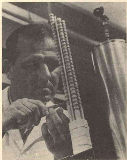
Nella foto è illustrata la costituzione di una batteria a pile a combustibile ad elettrolita solido.
